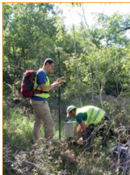
Photographie d'un gravimètre relatif sur trépied haut lors d'une prise de mesure gravimétrique (à gauche), Photographie d'une mesure simultanée GPS et gravimètre sur trépied bas (à droite)
