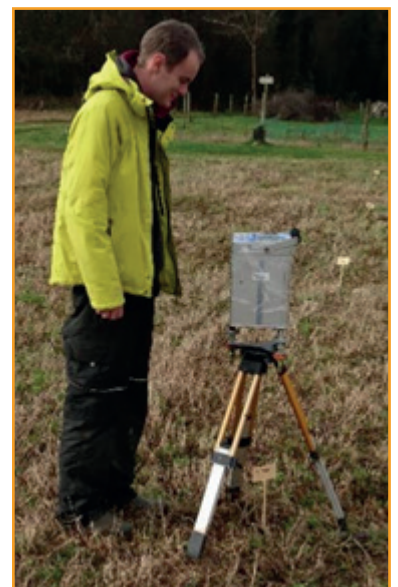
Photographie d'un gravimètre relatif sur trépied haut lors d'une prise de mesure gravimétrique (à gauche), Photographie d'une mesure simultanée GPS et gravimètre sur trépied bas (à droite)
